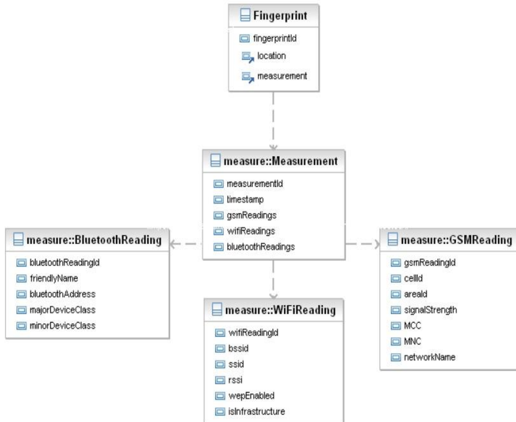
3. ábra: Lenyomatképzés a kliens-eszköz szenzor-adataiból
